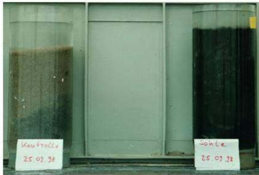
Abb. 6: Sedimentkerne. Beide Sedimentkerne wurden im Sommer 1998, 10 Monate nach dem Abbau, gestochen. Der linke Kern entstammt dem ungestörten Kontrollgebiet, der rechte Kern wurde aus der Sohle einer Baggerfurche entnommen.
