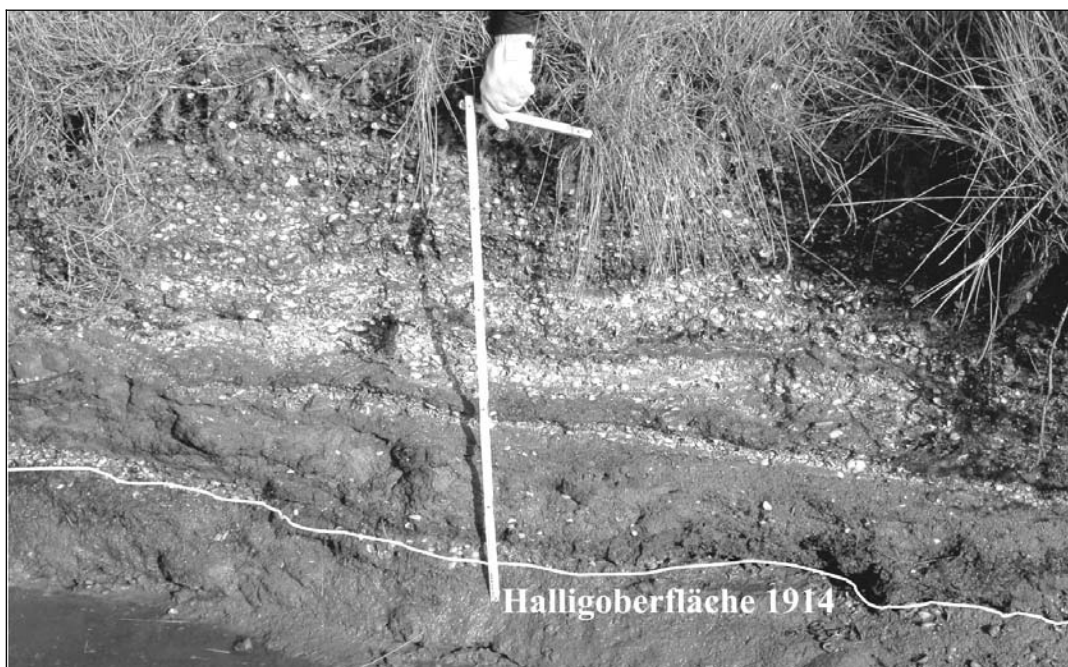
Abb. 3: Deichnaher Aufschluss. Die Mächtigkeit des jüngeren Sedimentes beträgt hier ca. 1 m. Die Schilllagen wurden in einem schnell strömenden Milieu auf der Deichinnenseite abgelagert. Die unterste Schilllage markiert dementsprechend den Beginn der Sedimentation nach dem Deichbau 1914.
